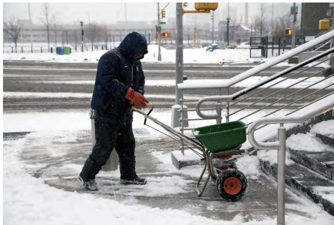
Figure 3.9-5 : Exemple d'épandeur à sel de petit format, aussi disponible en version liquide, EpandeuseGranby©
