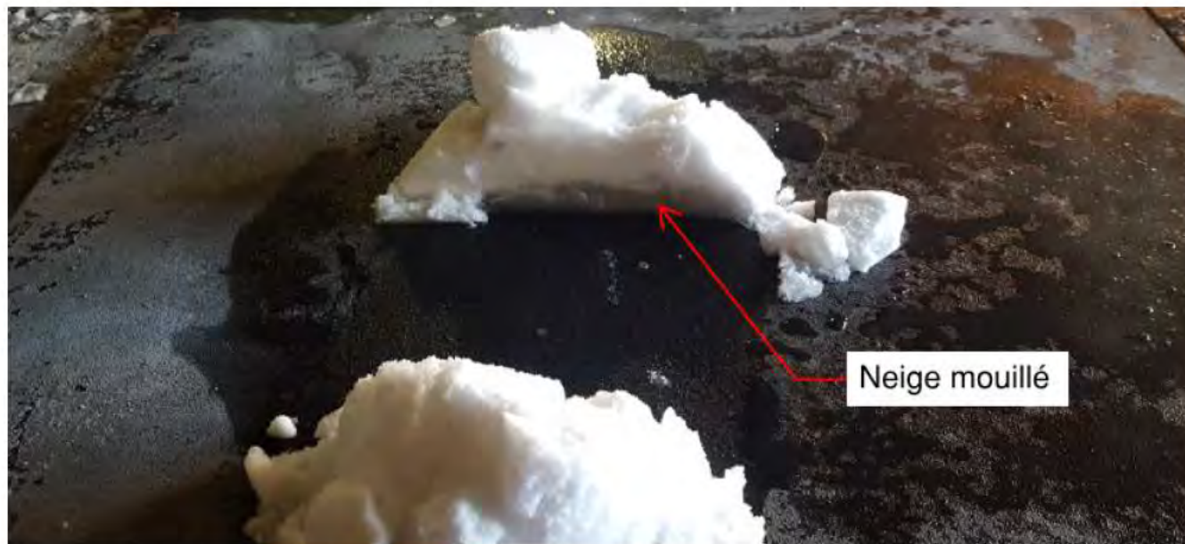
Figure 8 Section d'un monticule de neige après 25 minutes de fonte
