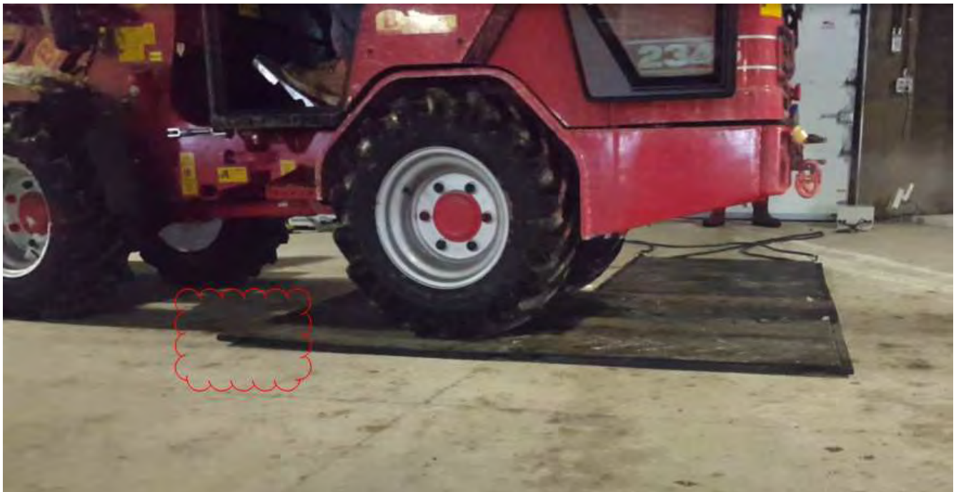
Figure 2 Soulèvement du coin des tapis dû au passage du camion de déneigement
