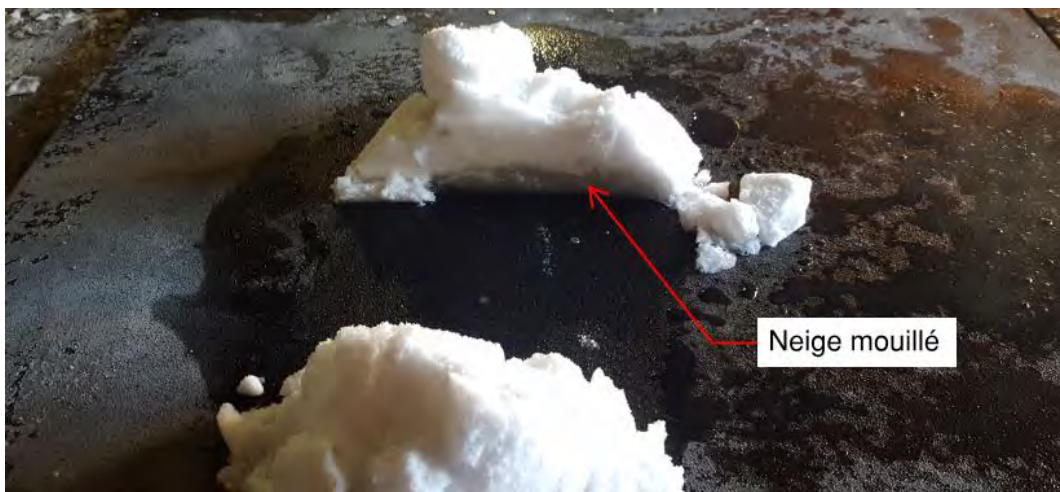
Figure 6.4-3 : Section d'un monticule de neige après 25 minutes de fonte
