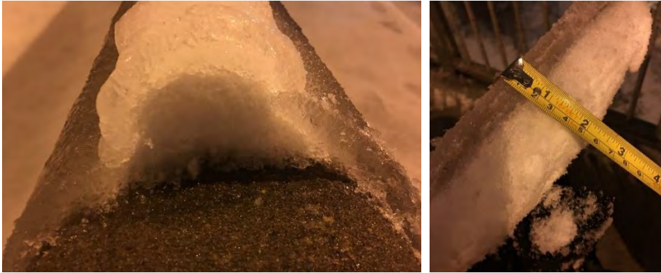
Figure 3.7-13 : Couche de neige couverte par une couche de glace, suite à la tempête de verglas du 23 janvier 2018.
