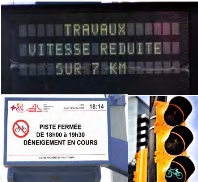
Figure 9.3-5 : écrans/ panneaux à message variable (PMV) et feu de signalisation affichant l'état de la piste multifonctionnelle
