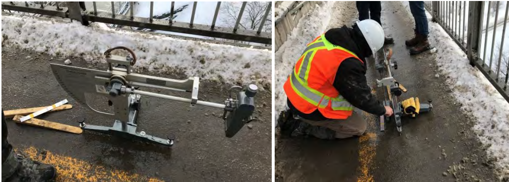
Figure 3.6-4 : British Pendulum (BP) utilisé lors du projet pilote (à gauche) ; exécution des mesures de glissement sur la piste multifonctionnelle du pont Jacques-Cartier (à droite)
