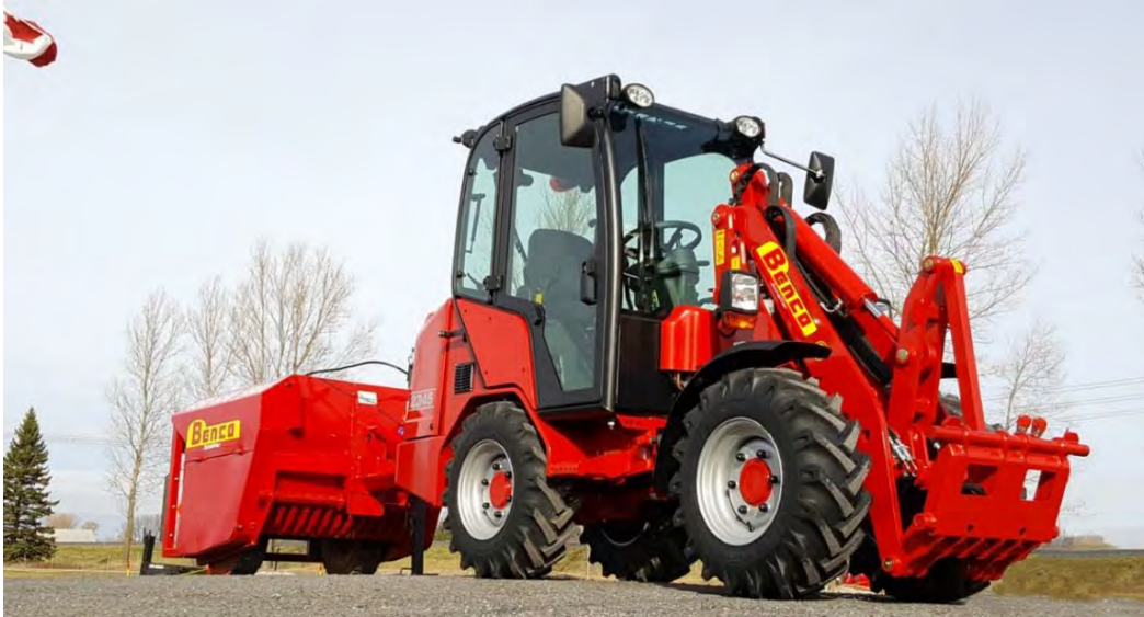
Figure 3.2-1 : Exemple de camion compact articulé (avec pelle devant et épandeuse des produits solides derrière)
