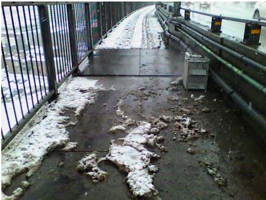
Figure 6.4-17 : La section 70 W/m 2 affiche toujours de la neige suite à 2 heures d'activation
