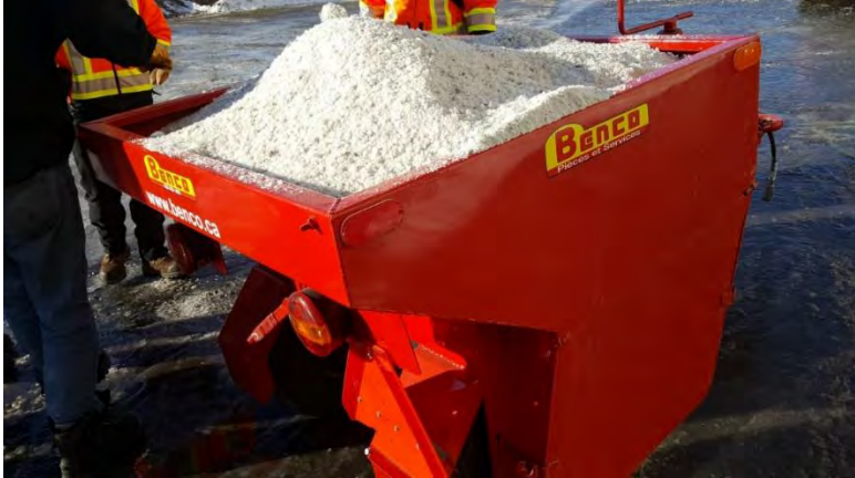
Figure 3.2-3 : Exemple de remorque avec épandeur de produits solides
