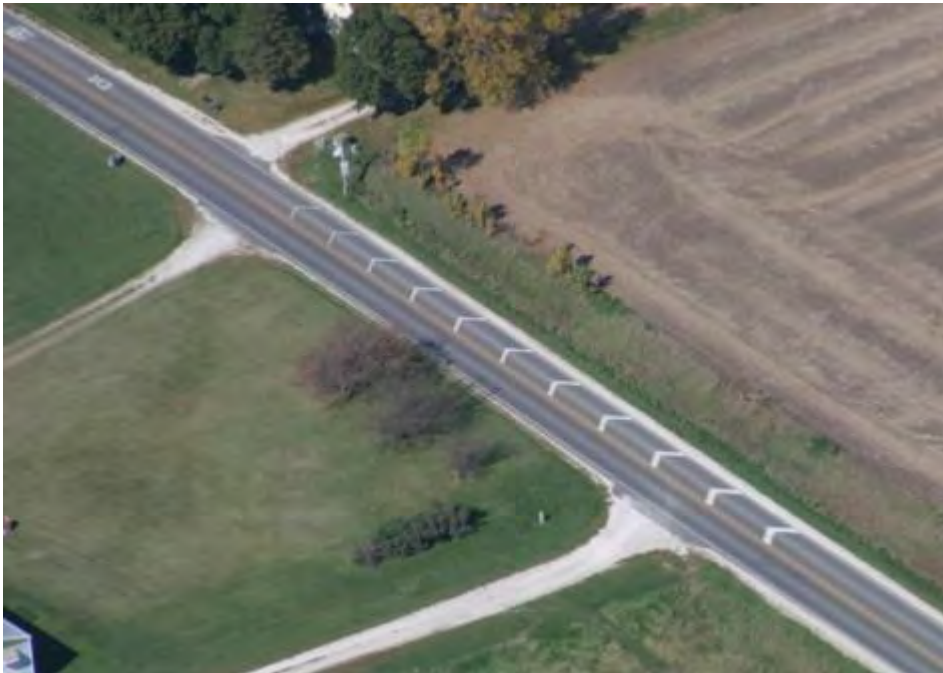
Figure 7.5-2 : Exemple de marquage de vitesse au sol avec bandes rapprochées
