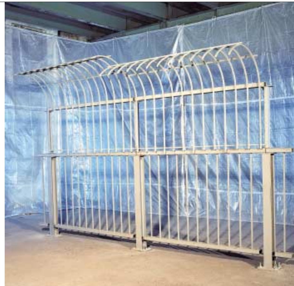
Exemples de prototypes fabriqués pour surélever la rampe existante du pont Jacques-Cartier afin de prévenir les tentatives de suicides.
